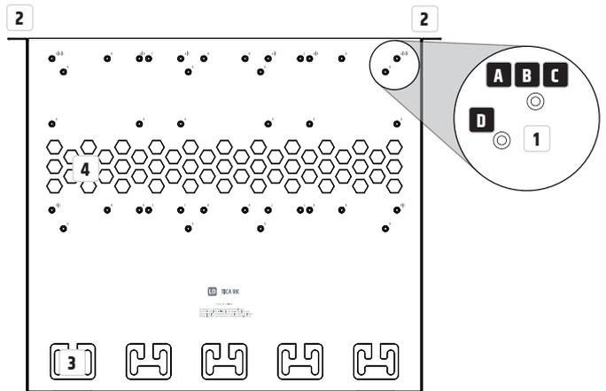
Im Lieferumfang sind Frontblenden in verschiedenen Breiten enthalten. Die entsprechende Frontblende wird für eine geschlossene Front in eine Lücke zwischen zwei Geräte an der Rackwanne festgeschraubt **A**.
